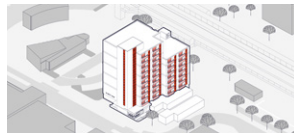
puien, kozijnen & balustrades vervangen
