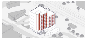
puien, kozijnen & balustrades vervangen
